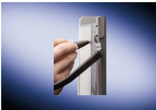
El panel frontal con pantalla táctil y teclas está concebido como unidad frontal para Panel PC. La combinación del manejo con pantalla táctil y teclas, además de la resistencia a lubricantes para rectificadora, distinguen este producto.
