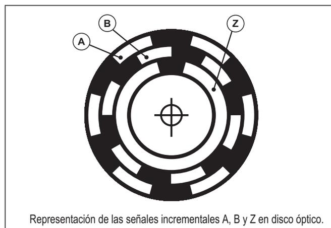
La precisión de un encoder incremental depende de factores mecánicos y eléctricos entre los cuales, el error de división del retículo, la excentricidad del disco, la de los rodamientos, el error introducido por la electrónica de lectura, imprecisiones de tipo óptico.
